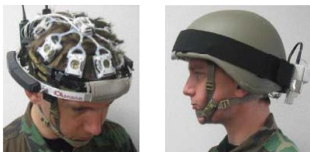
图 1-8 QUASAR 公司开发的军用无线脑电头盔
