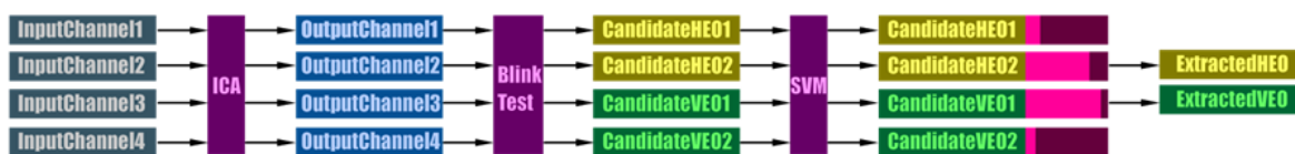
图 4-6 从前额信号中抽取 HEO 与 VEO 的一般流程图
